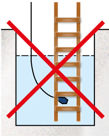
Abbildung 4. Achten Sie darauf, dass der Schwimmkörper ungehindert schwimmen kann.
